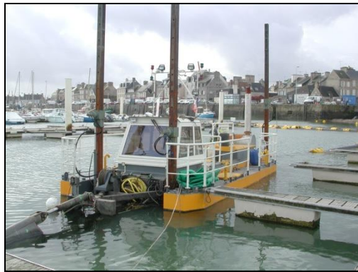
Figure 18 : Drague hydraulique stationnaire au port de Saint-Vaast en 2000 (source : MARC SA)
